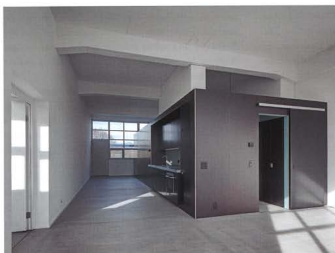
Wohnhalle mit eingestelltem Installationskern
