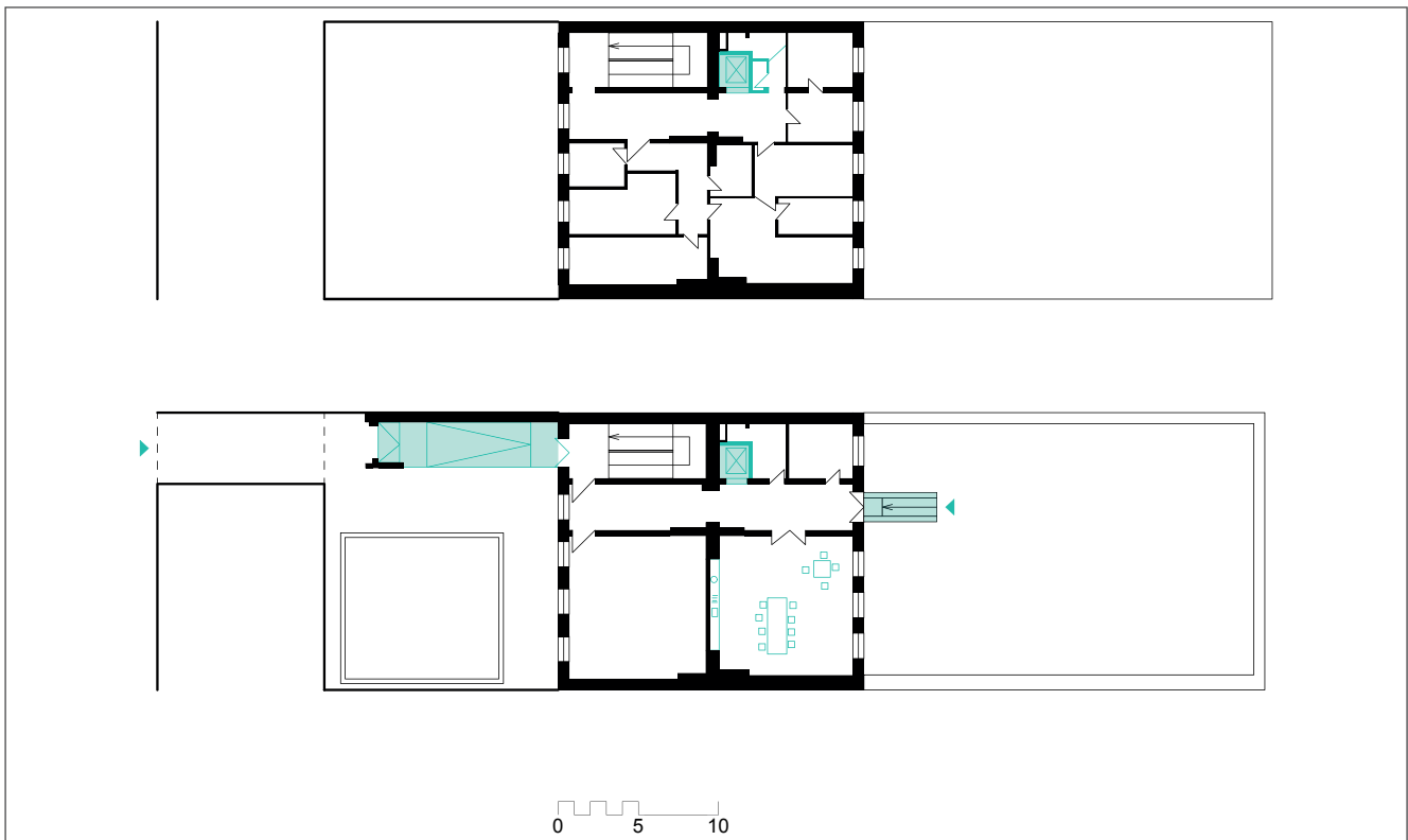
Abb. 114: Die Grundrisse des EG und 2. OG mit Maßnahmen für die Barrierefreiheit (grün) © Gabu Heindl Architektur, Bearbeitung subsolar*
